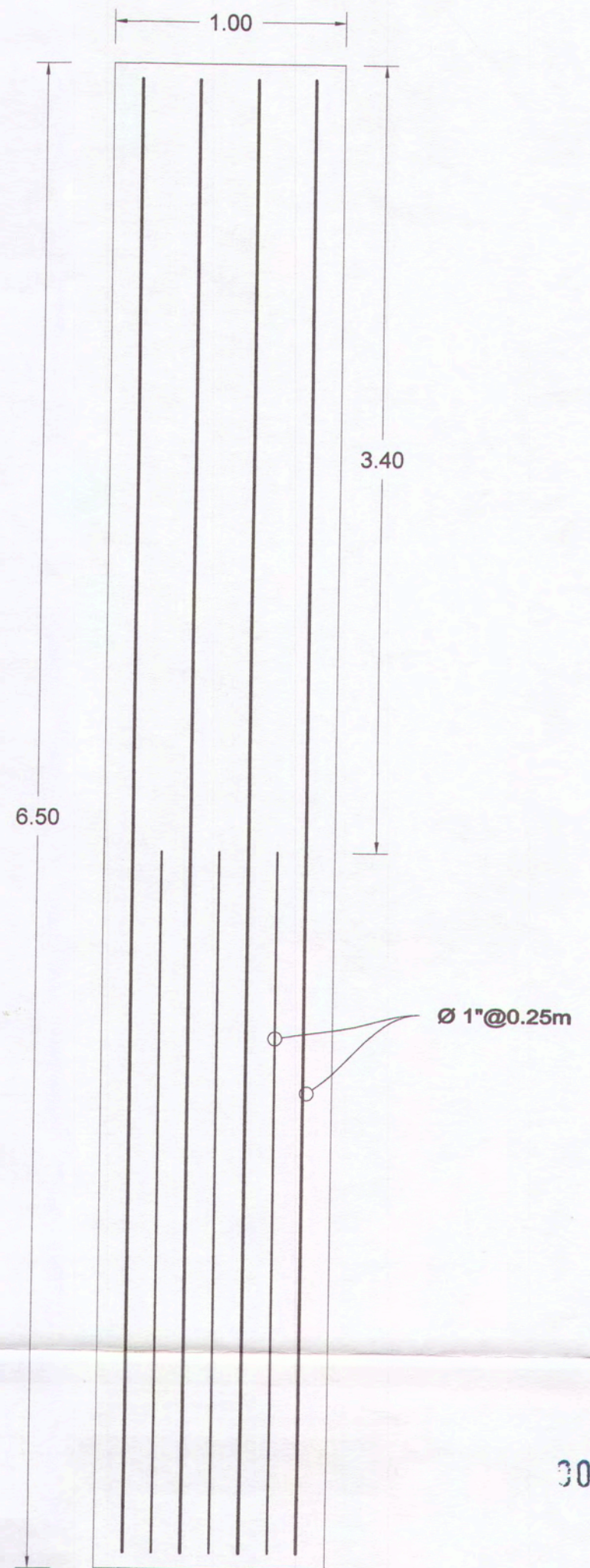
Detalle de refuerzo acero (intervalo 1m.) ESCALA ..... 1/25
