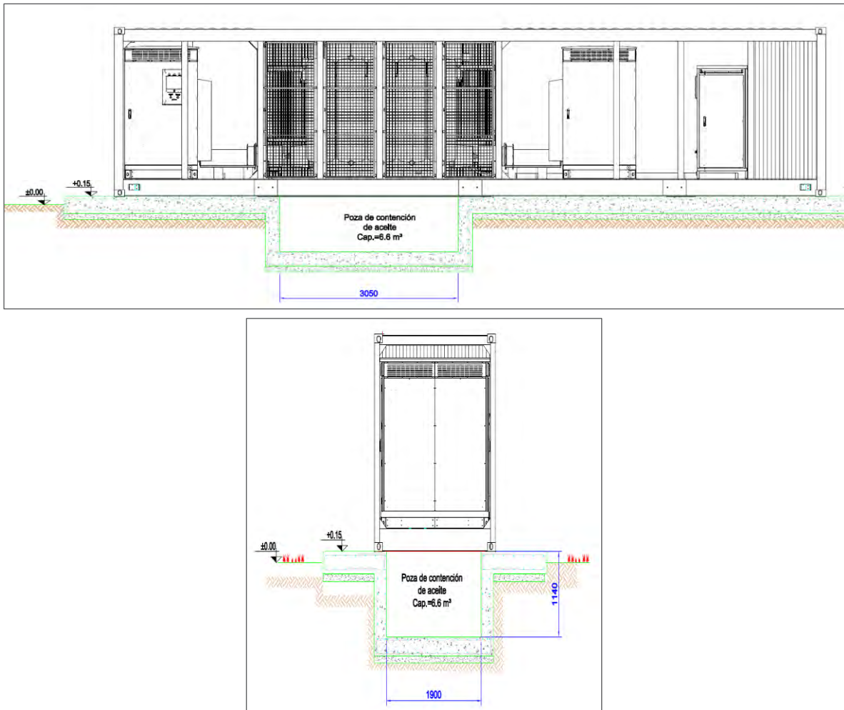
Figura 2.4-6: Sistema de contención de derrame de aceite en los centros de transformación
