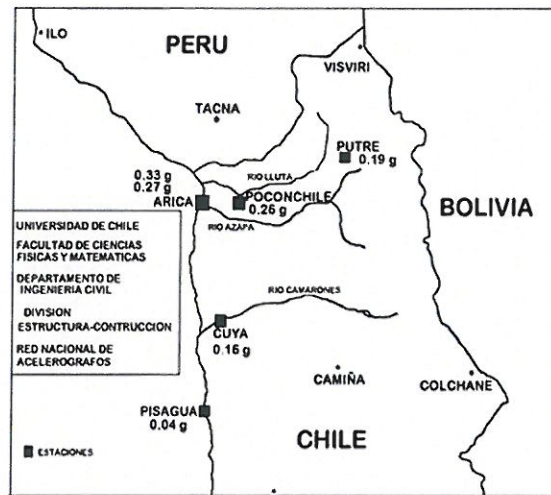
Figura N° 7.- Datos de aceleración obtenidos en Arica por la Universidad de Chile (Boroshek). Fuente CISMID UNI (año 2001) http://www.cismid.uni.edu.pe/descargas/redacis/redacis46_p.pdf
