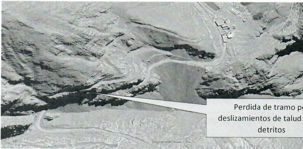
Perdida de tramo por deslizamientos de talud y flujo de detritos
