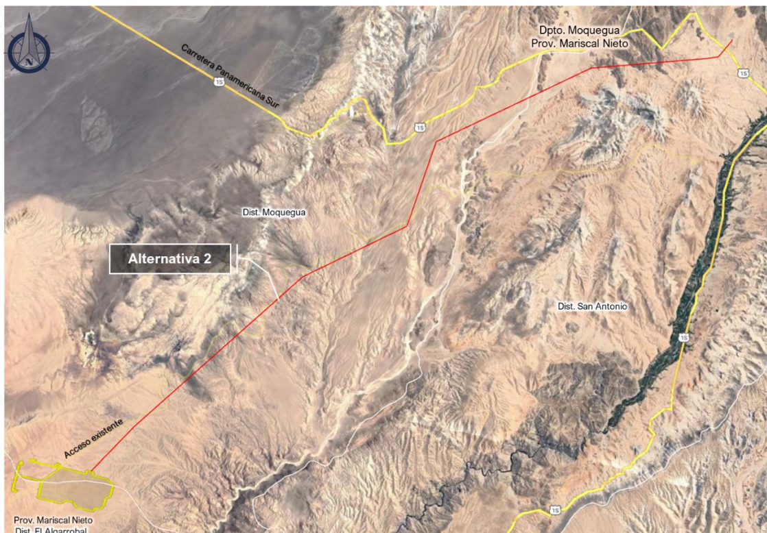
Figura Obs. 1-5 Configuración de la Línea de transmisión 220 kV (alternativa 2)
