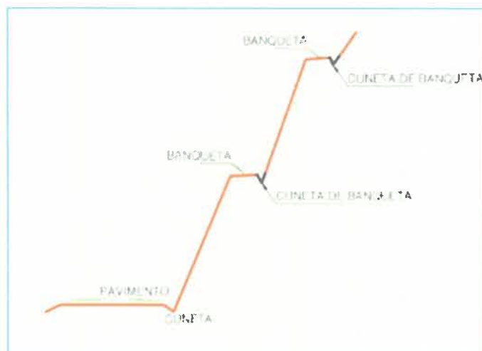
GRAFICO 1: Estabilización de taludes con banquetas
