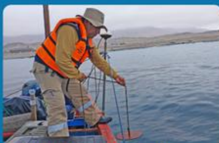
ESTUDIO BATIMÉTRICO EN REFINERÍA - INSTALACIÓN DE ANTENA GPS DEL ECOSONDA
