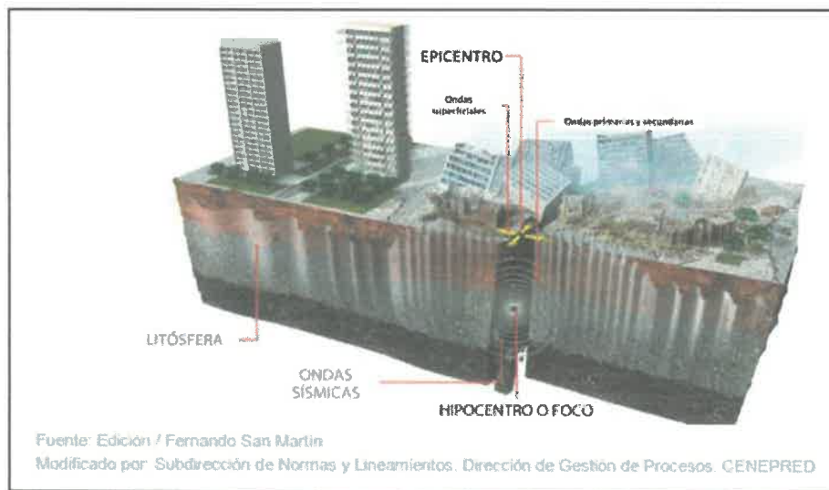
Ilustración 22. Efectos de las ondas sísmicas en edificaciones
