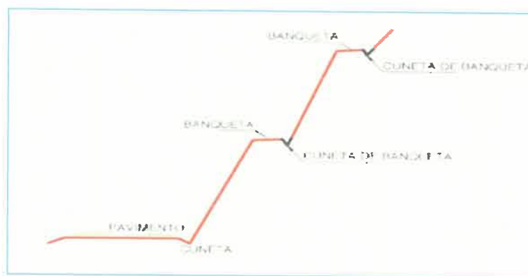
GRAFICO 1: Estabilización de taludes con banquetas
