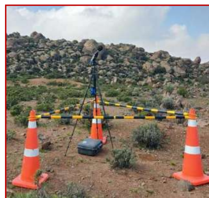
Estación de Ruido Ambiental
