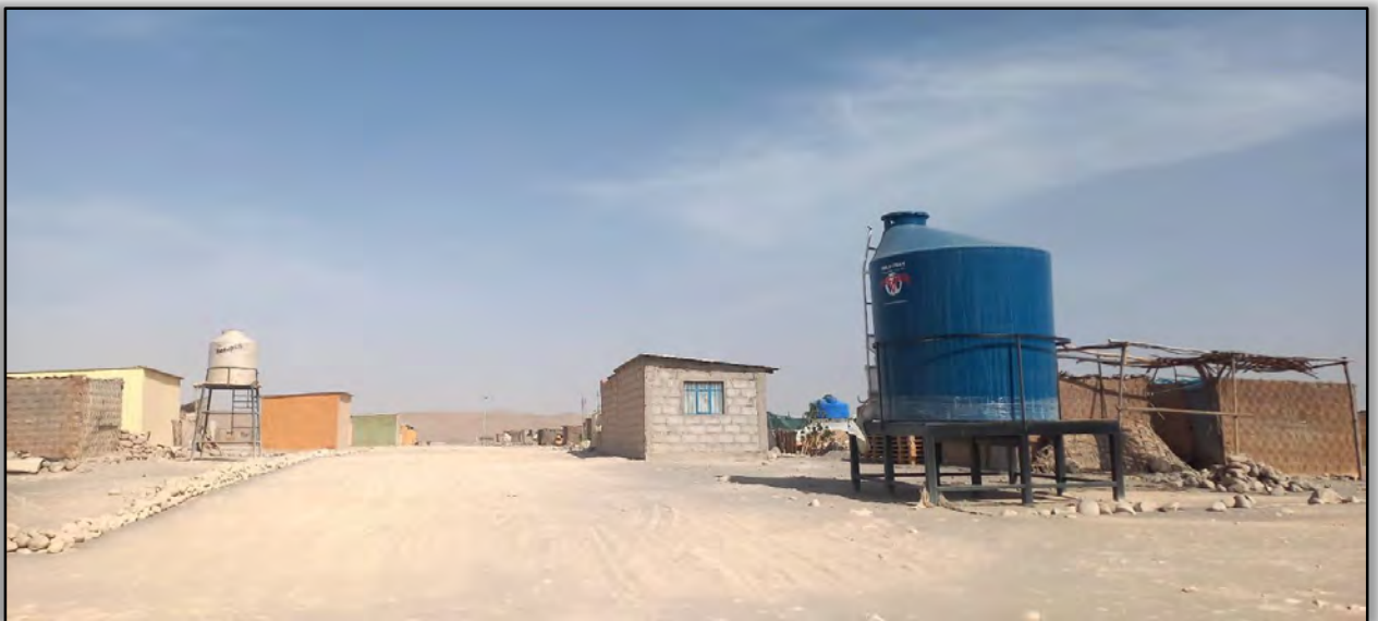
FOTO 09: Vista del sector terreno con presencia de viviendas, y reservorios de agua (tanques pre fabricados de polietileno, instalados sobre estructura metálica), para uso de piletas públicas.
