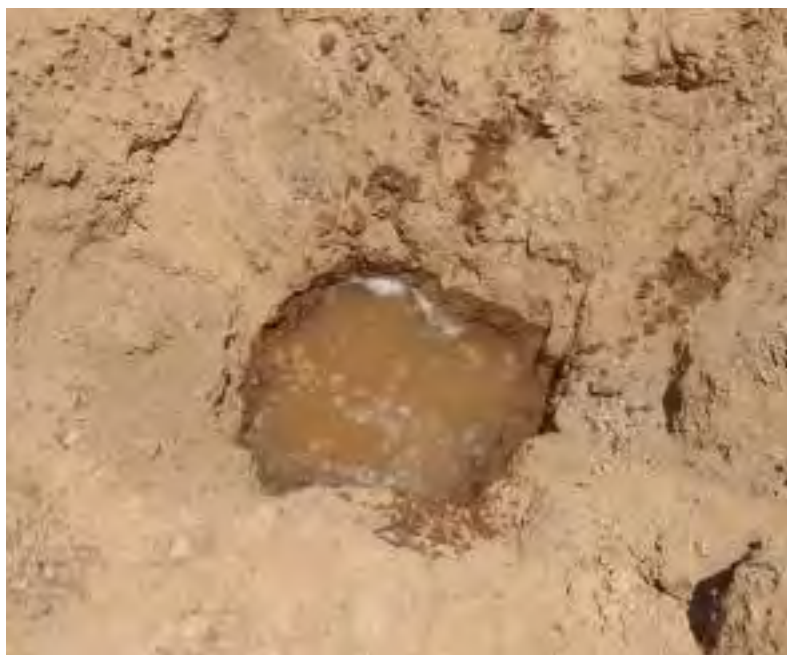
Foto 5. Saturación del agujero antes de iniciar la medición de descenso del nivel de agua en la calicata N.º 02
