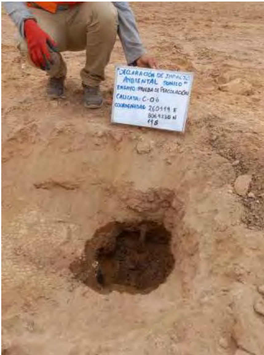
Foto 18. Medición del descenso de agua en la calicata N.º 06
