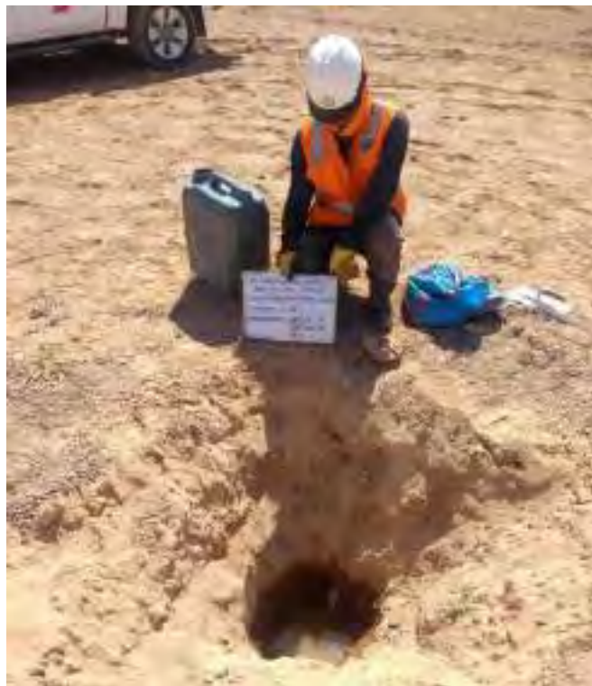
Foto 3: Medición del descenso de agua en la calicata N.º 01
