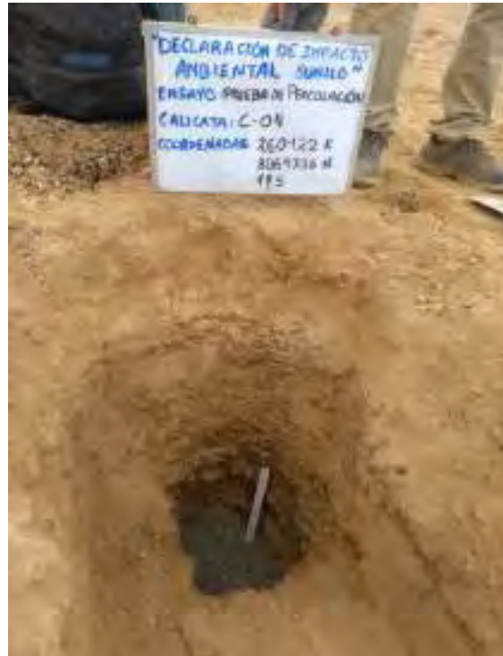
Foto 10. Colocación de la capa de grava para el inicio del test de percolación en la calicata N.º 04
