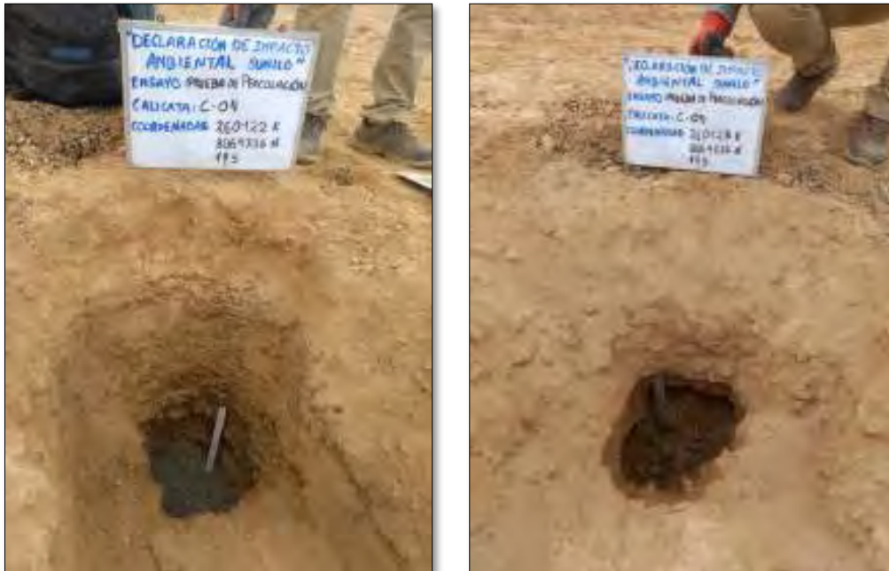
Figura 3 Pruebas de percolación en calicatas C04 y C05
