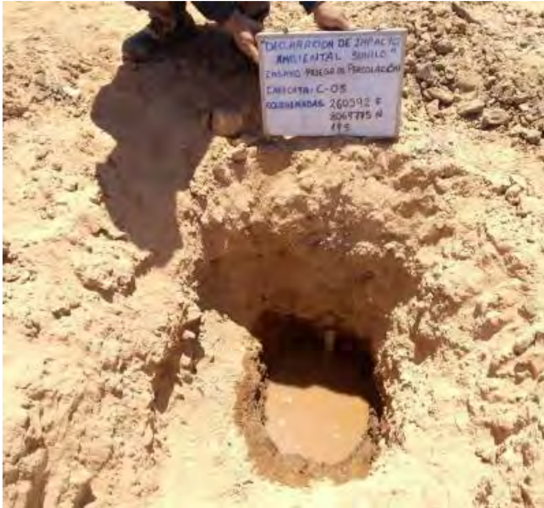
Foto 9. Medición del descenso de agua en la calicata N.º 03
