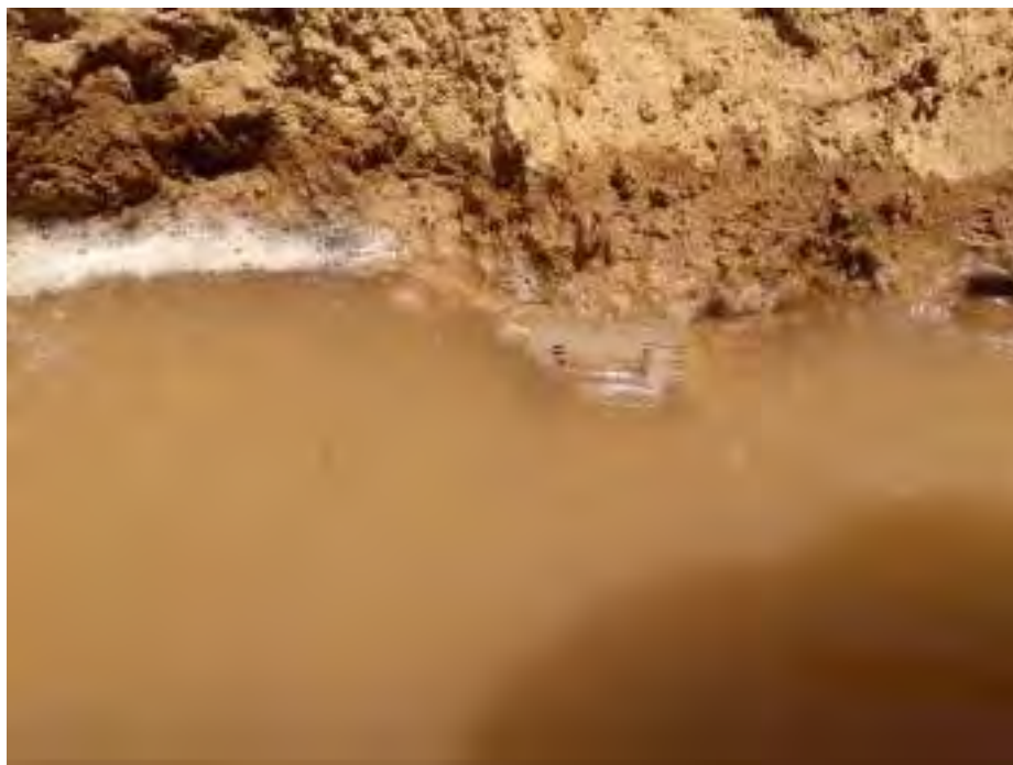
Foto 8. Saturación del agujero antes de iniciar la medición de descenso del nivel de agua en la calicata N.º 03
