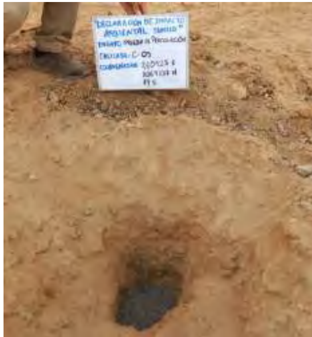
Figura 13. I Colocación de la capa de grava para el inicio del test de percolación en la calicata N.º 05
