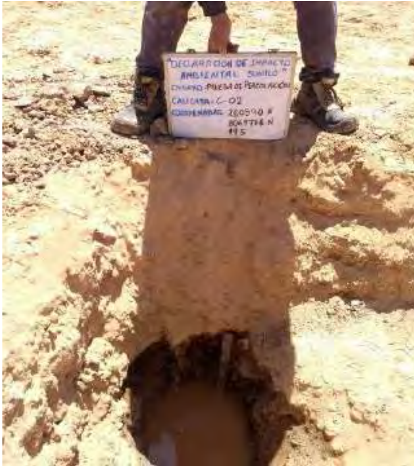
Foto 6. Medición del descenso de agua en la calicata N.º 02
