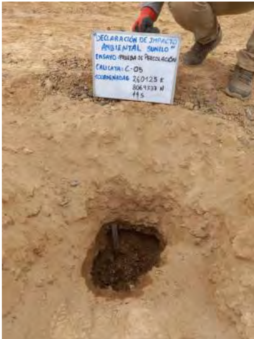
Foto 15. Medición del descenso de agua en la calicata N° 05
