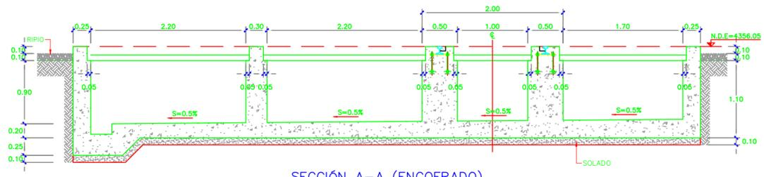
SECCIÓN A-A (ENCOFRADO)
