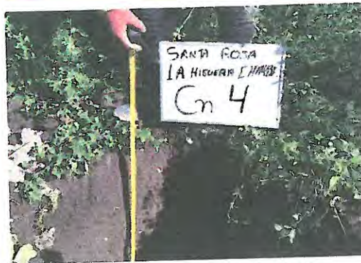
CALICATA Nro. 4 – Altura H= 1.80 mts
