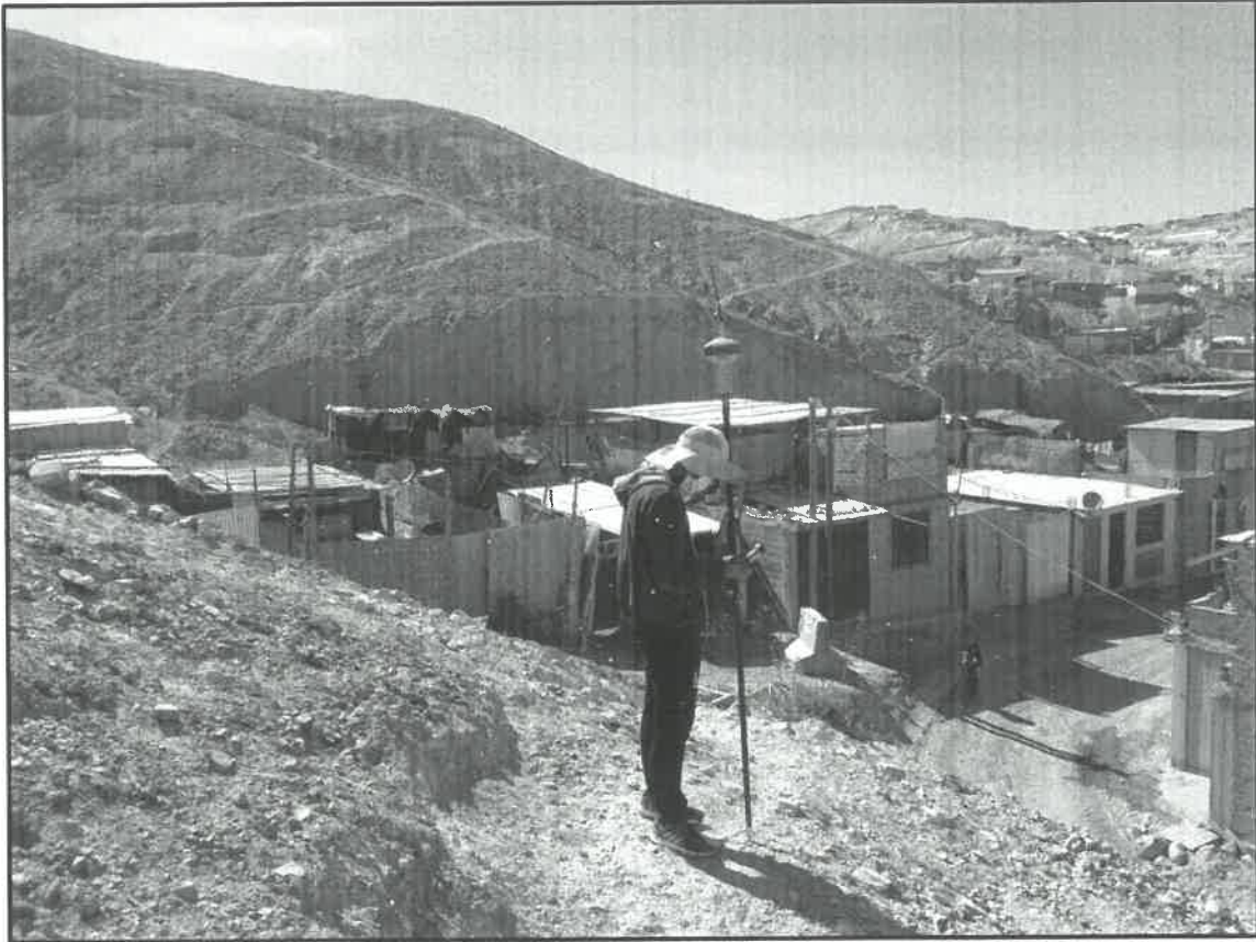
Foto N°7: Levantamiento topográfico de zonas accidentadas
